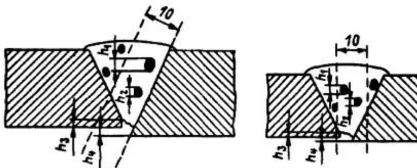
Рис. 18.8. Схема подсчета показателя концентрации дефектов ( $K_d$ ):
