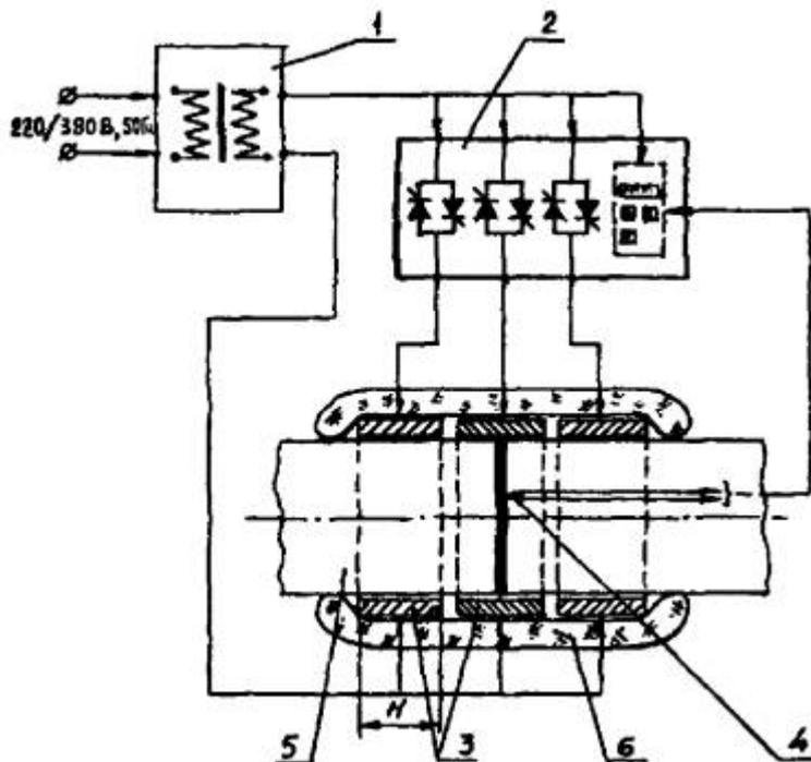
Рис. 17.6. Схема подключения нагревателя ГРЭН к источнику питания:
