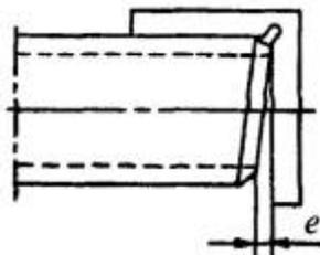
Рис. 6.1. Схема проверки перпендикулярности торцов труб
