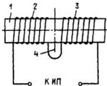
Рис. 17.2. Двухсекционный гибкий индуктор:
