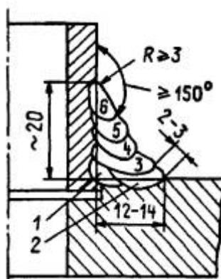
Рис. 7.24. Схема расположения роликов и размеры шва приварки штуцера (трубы) к коллектору (трубопроводу) без последующей термообработки:
