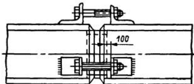
Рис. П11.1. Сборка на стяжных уголках стыков труб диаметром более 100 мм
