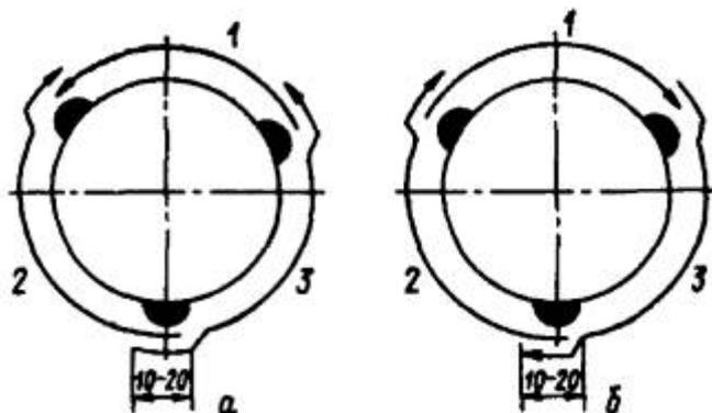
Рис. 8.2. Направление и порядок ручной аргонодуговой сварки корневого слоя вертикального (а) и горизонтального (б) неповоротных стыков:
