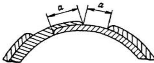
Рис. 6.8. Схема наложения «замков» швов
