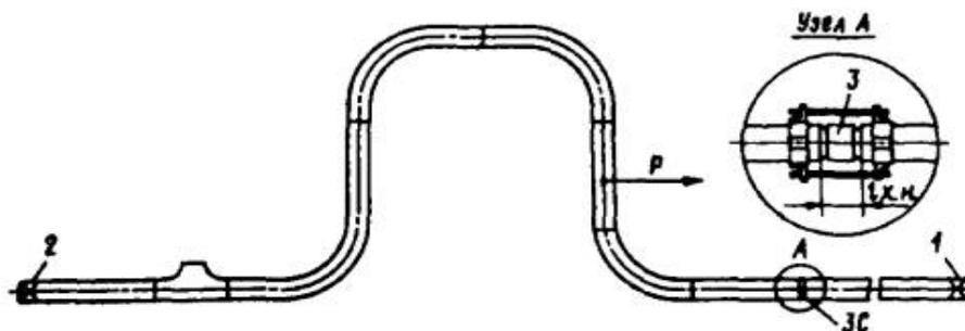
Рис. 6.7. Схема сборки и сварки замыкающего стыка при холодном натяге:
