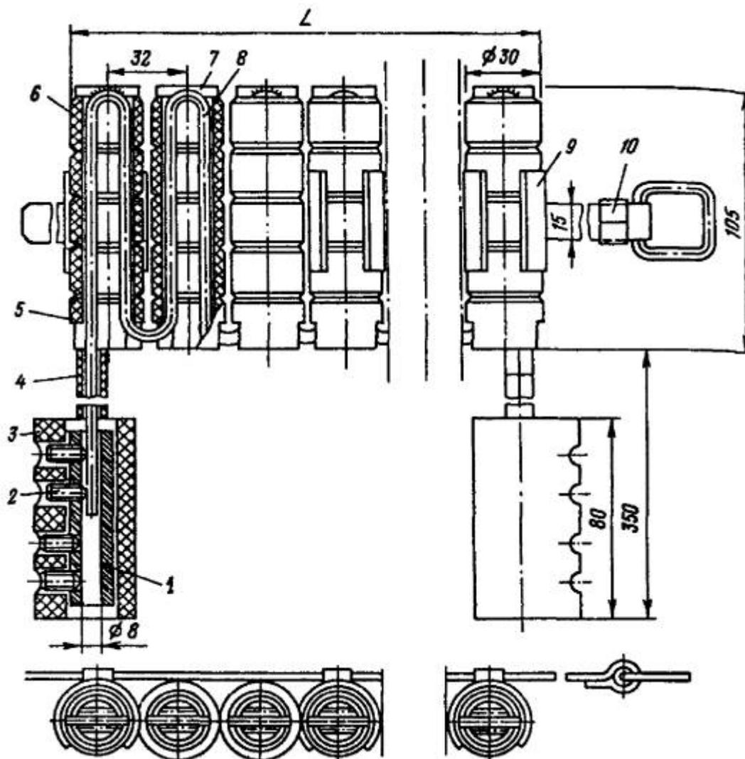
Рис. 17.4. Гибкий пальцевый электронагреватель сопротивления ГЭН:
