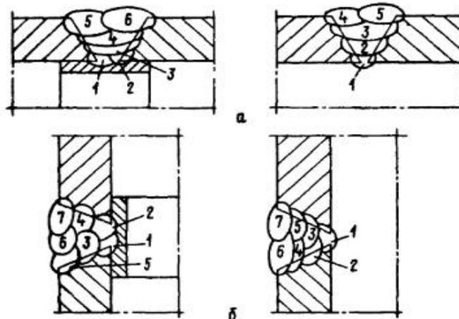
Рис. 7.15. Примерное расположение слоев и валиков при ручной дуговой сварке вертикального неповоротного (а) и горизонтального (б) стыков газопроводов с толщиной стенки труб более 12 мм:
