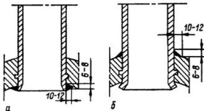
Рис. 20.6. Устранение неплотностей вальцовочных соединений с помощью сварки:
