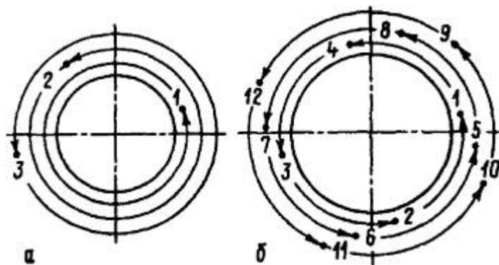
Рис. 7.5. Порядок наложения слоев (валиков) при сварке одним сварщиком горизонтальных стыков труб:
