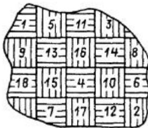
Рис. 20.1. Заплавка раковины
