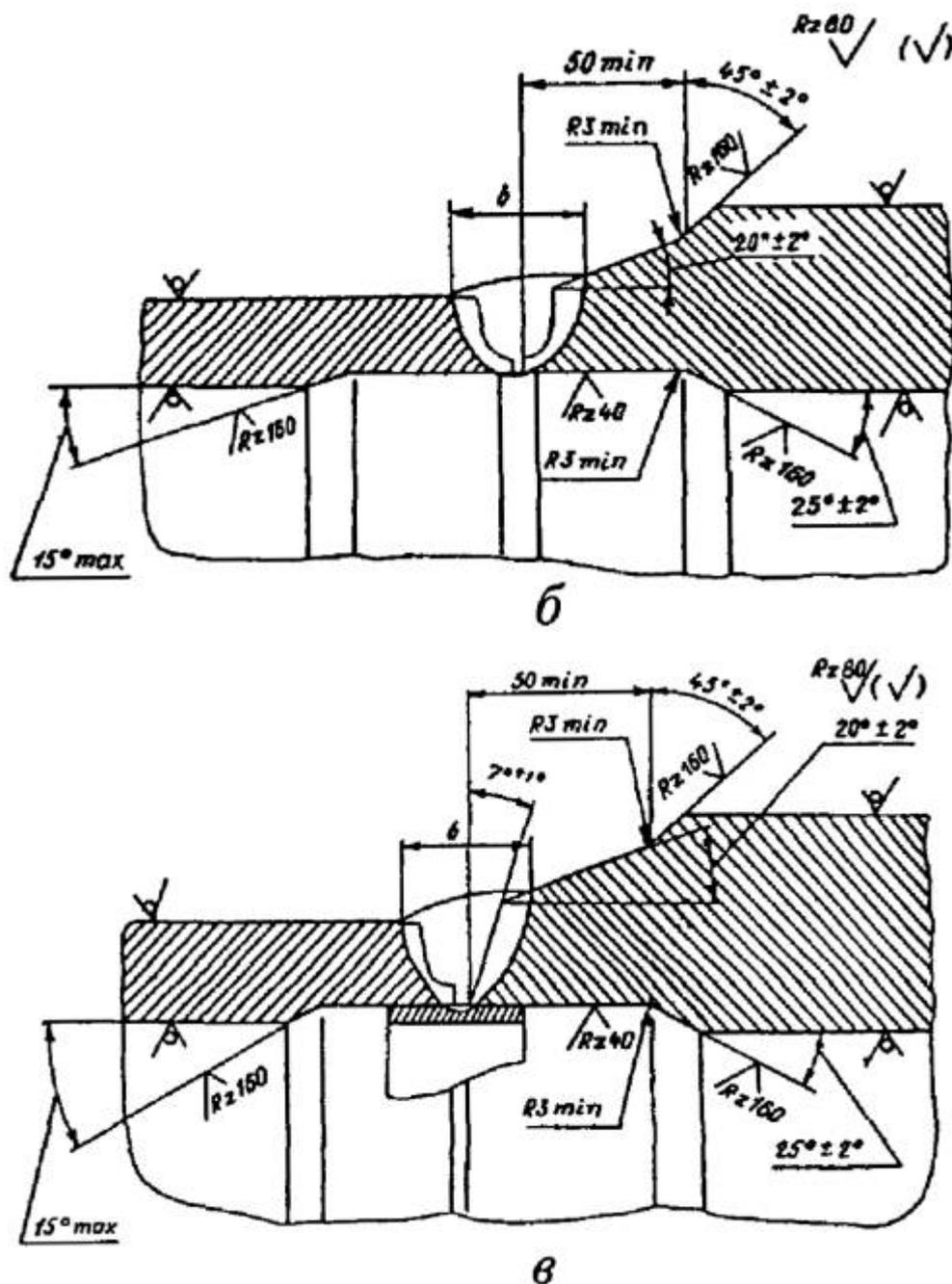
Рис. 6.4. Схема обработки концов труб при стыковке элементов, имеющих разные наружные диаметры:
