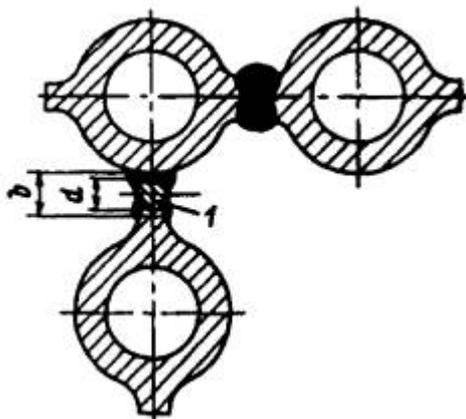
Рис. 16.4. Соединение стенок газоплотных панелей:
