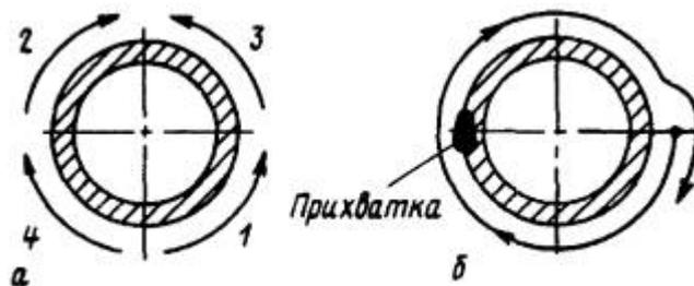
Рис. 7.14. Схема сварки одним сварщиком вертикального (*а*) и горизонтального (*б*) стыков труб поверхностей нагрева:
