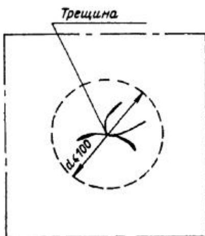
Рис. 20.3. Исправление скопления трещин путем варки заглушки
