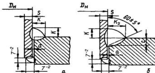
Рис. 7.18. Приварка плоских фланцев к трубе:
