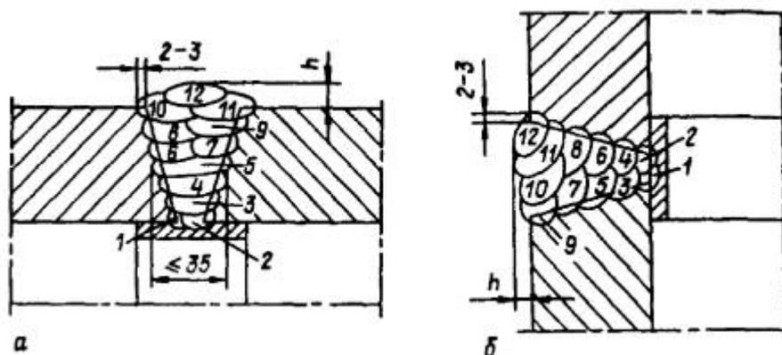
Рис. 11.3. Примерное расположение слоев и валиков по сечению шва вертикального неповоротного (а) и горизонтального (б) стыков труб с разделкой Тр-Зв (угол скоса  $15^\circ$ ), выполненных механизированной сваркой в среде углекислого газа:
