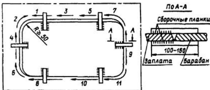
Рис. 20.4. Установка заплаты на сборочных планках
